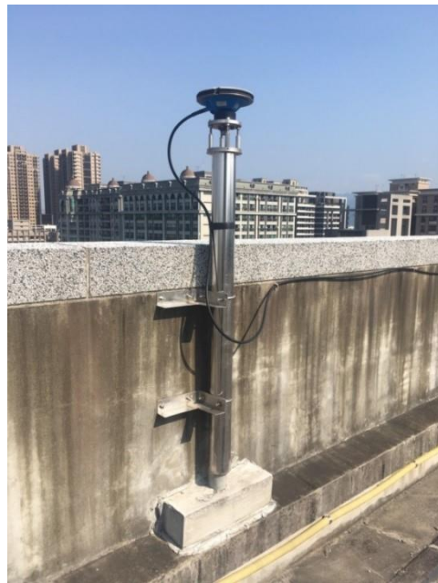
圖 4 Topcon GRS-1 衛星接收儀、圖 5 用於架設衛星儀器之固定樁 Topcon PG-A1 天線盤
